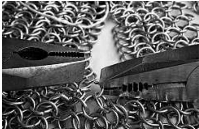
13: Die Ringe werden mit der Zange aufgebogen und nach dem Einhängen wieder zusammengebogen.
